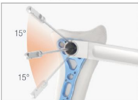
Guia de broca para inserção de parafuso poliaxial
